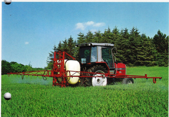
Fotet visar en NK spruta med mekanisk ramphöjare (extra tillbehör).
